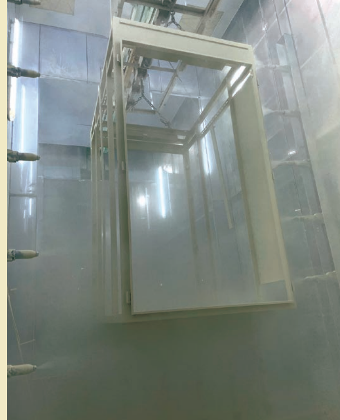
粉体塗装システムは、1レシプロ5ガン×2基(対面式)+底面6ガン(固定ガン)で、計16丁の自動ガン(ECXa)が配されている
