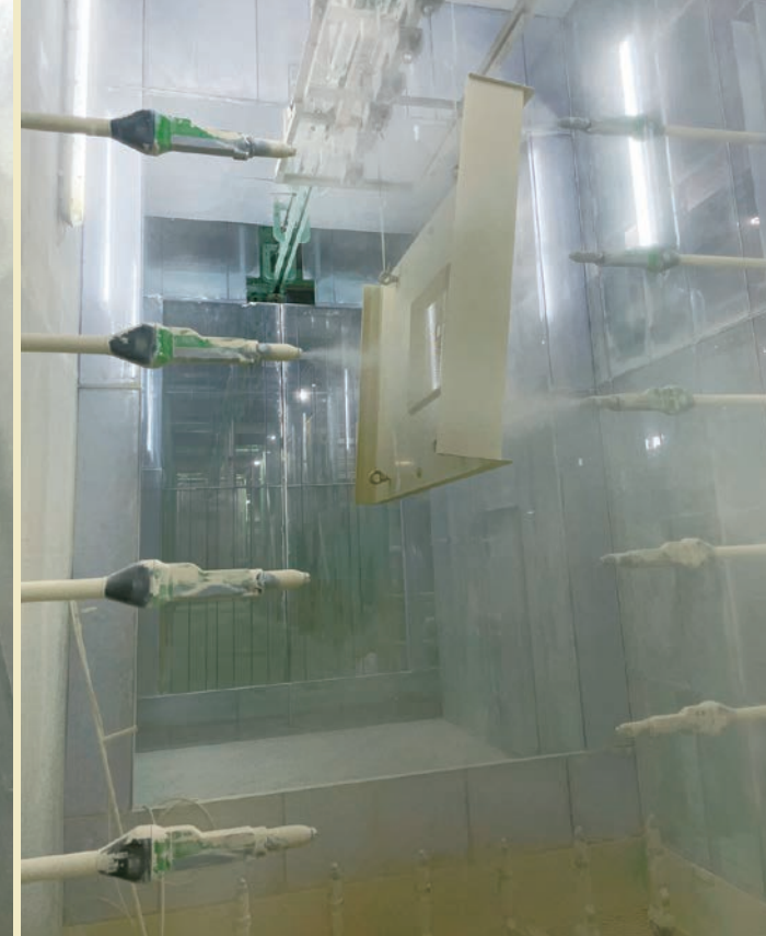
粉体塗装システムは、1レシプロ5ガン×2基(対面式)+底面6ガン(固定ガン)で、計16丁の自動ガン(ECXa)が配されている
