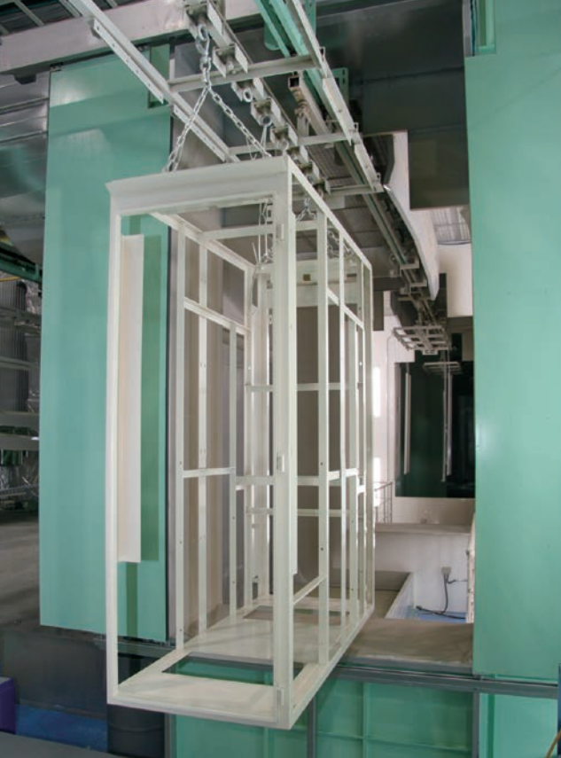
溶剤塗装ブースへ進行するワーク
