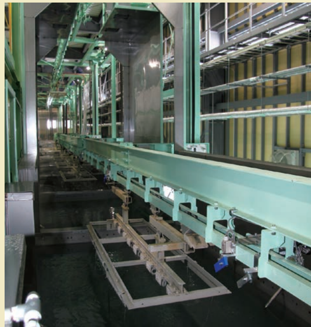
前処理工程はディップとスプレー方式を併用する
