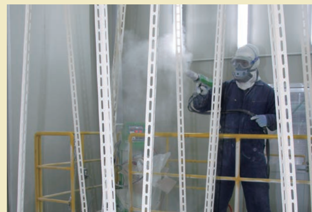
デュアル電界方式粉体ハンドガンによる補正塗装
