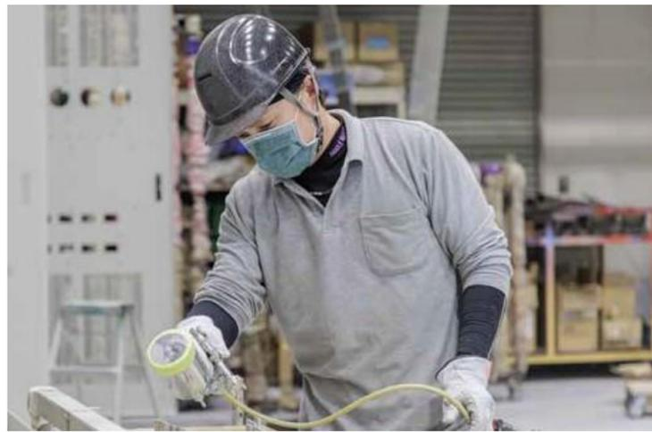
加工された鉄板の箱と扉、部材に色付けをします。
